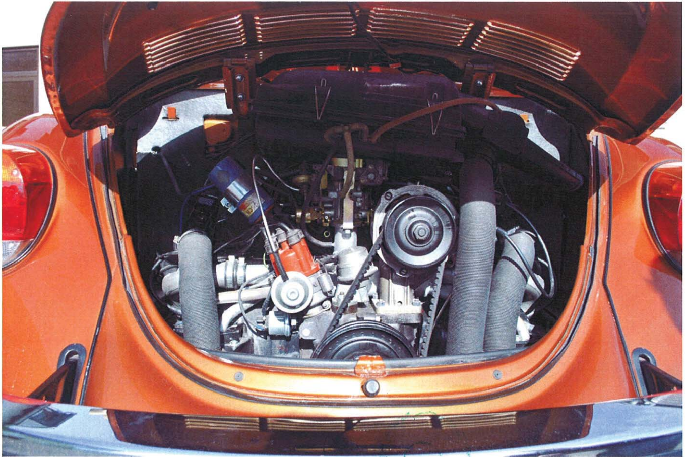
4-Zylinder Boxermotor mit der Motornummer AS.....
